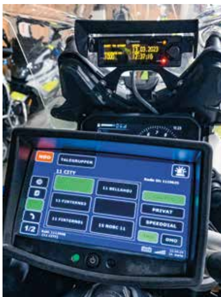
Bifrost-skærmen er eftermonteret på Ducati-motorcyklen. Betjeningen af systemet giver nogle sikkerhedsmæssige udfordringer, når der samtidigt skal køres stærkt.
